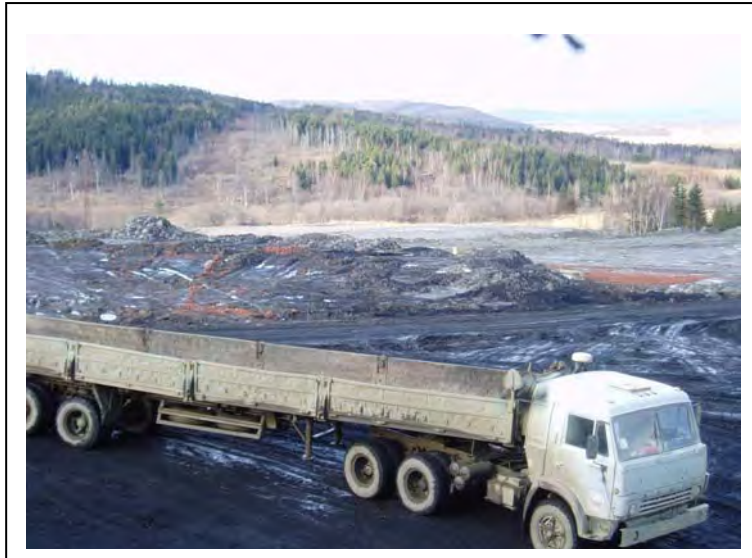
写真 2. 1. 6 ウグレゴルスク炭鉱の輸送用トレーラー(積載量 : 38 トン)
