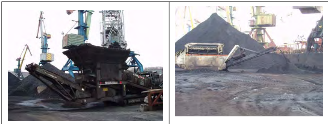
写真2.3.3 可搬式磁力選別機 (磁選機への石炭供給もクレーンである) (石炭会社がこの選別機を貸与し、2ドックで処理している。)
