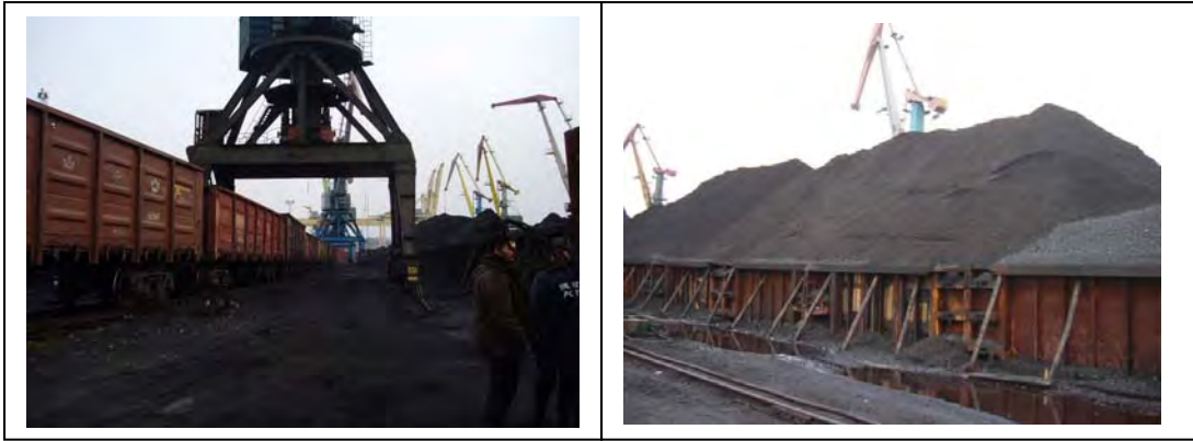
写真2.3.2 ワニノ商業港での貨車から石炭を積み降ろすクレーンと積み降ろした石炭の山 (クレーンで貨車から降ろすので、最終的には人力で石炭を降ろす。) (貨車の融雪施設はない。)
